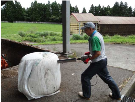
写真5 コアサンプラーによるサンプル採取
