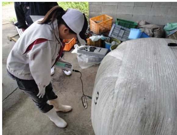
写真7 挿入pH計測定の様子
