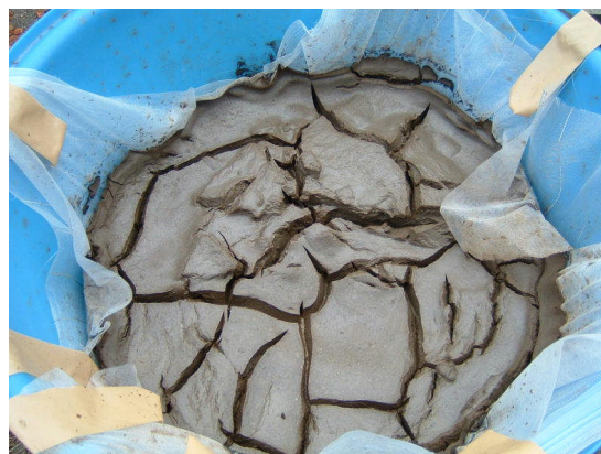
図 2 表面汚泥の状態
