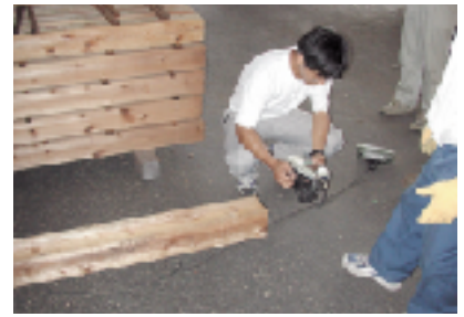
スギ動的ヤングの測定
