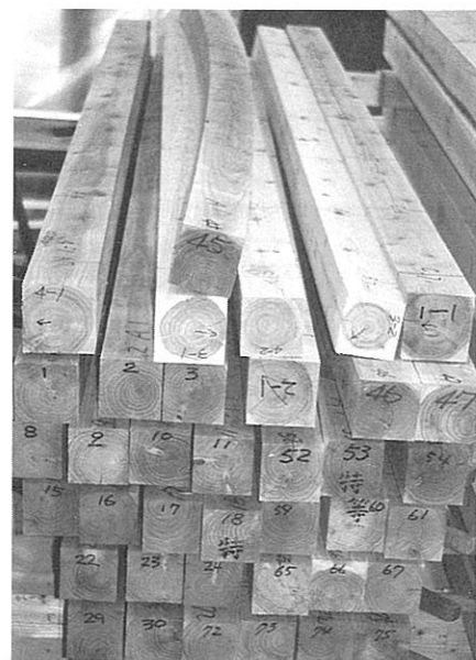
スギ柱材の乾燥試験により生じた曲り材
