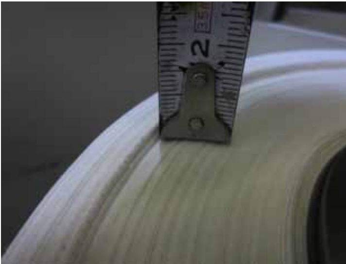
ろ紙巻取り状況 (上側にろ紙ずれ確認)
