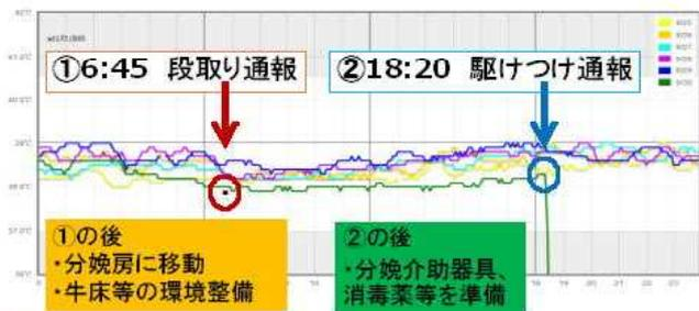
1次破水時に体温センサーが、体外に放出された変化を察知して「駆けつけメール」が通報される。
