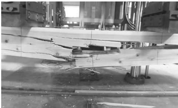
写真-7 引張破壊とせん断破壊の状況
