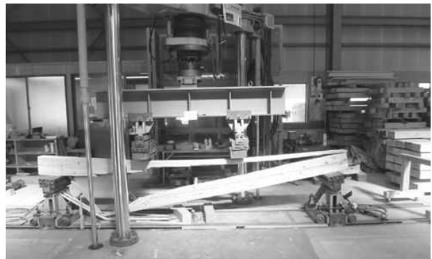
写真-8 荷重点間以外での破壊の状況
