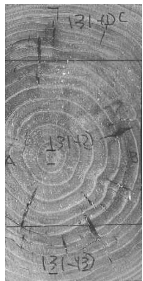
写真-8 荷重点間以外での破壊の状況
