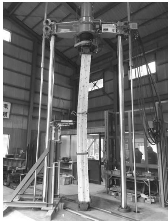
写真-1 座屈試験の様子
