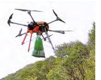
ドローンを活用した資材運搬
