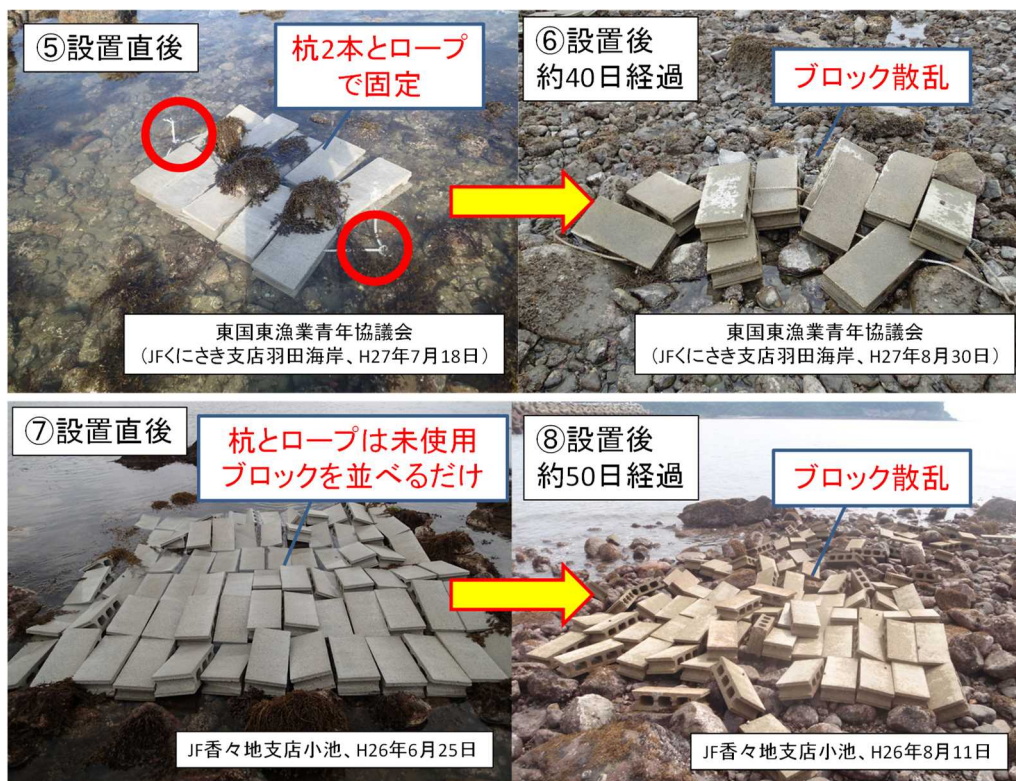
図Ⅱ-16 ブロック設置後の散乱の状況
