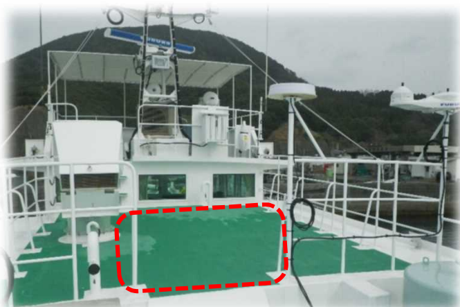
図11 マルチコプター発着用の上甲板
