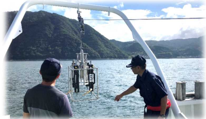
図13 Aフレームを用いた4筒式採水装置の昇降
