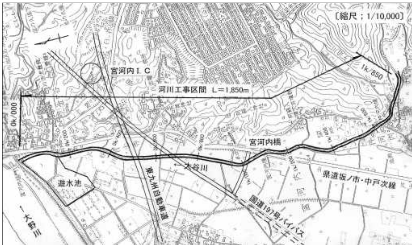
図6 河川工事の施行の場所 (大分市大字宮河内)
