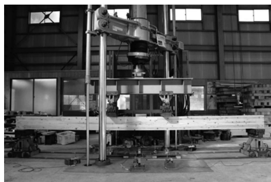
写真-1 曲げ試験の様子
