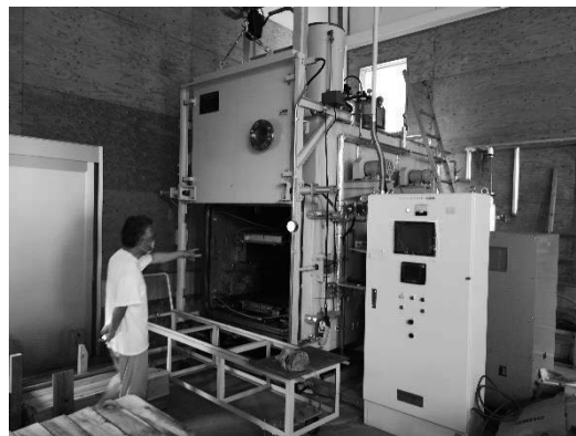
写真-2 多機能木材乾燥機 (高周波減圧乾燥機)
