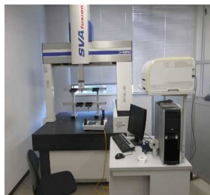
三次元測定機（県立工科短期大学校）
