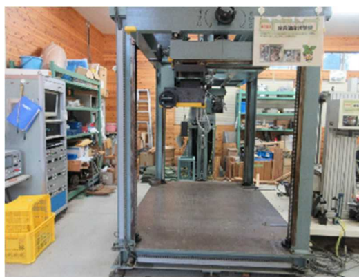
家具強度試験機 (農林水産研究指導センター林業研究部)
