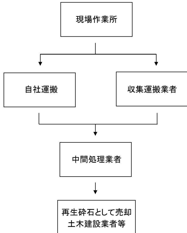
1. 各作業所より、解体等に伴い発生したコンクリート殻・アスファルト殻は現場責任者が管理し、マニフェストと共に収集運搬業・処分業者へ引き渡す。
