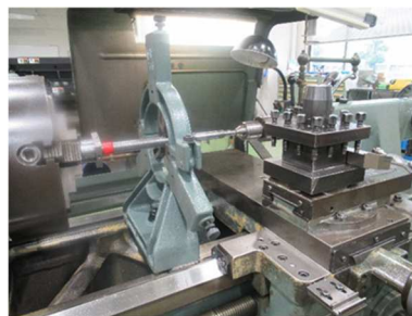
図7 固定振れ止めを使用した加工
