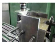
図5 柵ブロックを使用した段取り
