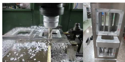
図13 軽量化窓加工と可視化
