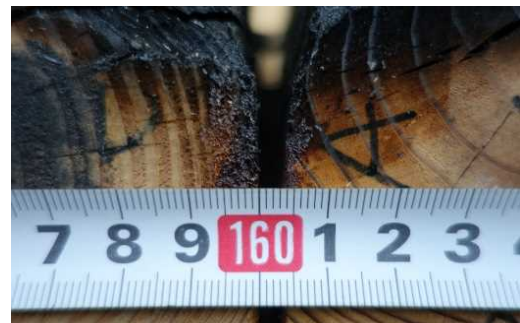
1時間燃焼試験後の合わせ柱の合わせ目
