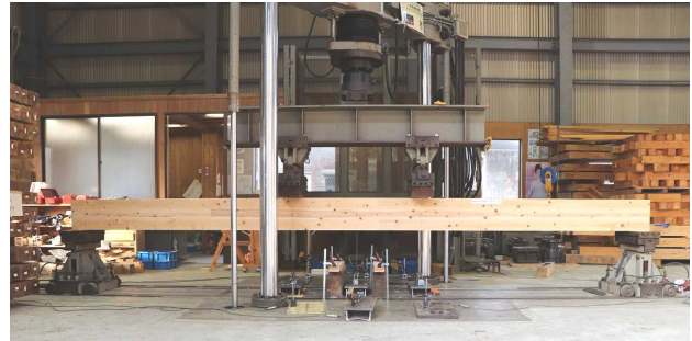
写真-5 曲げ試験の様子
