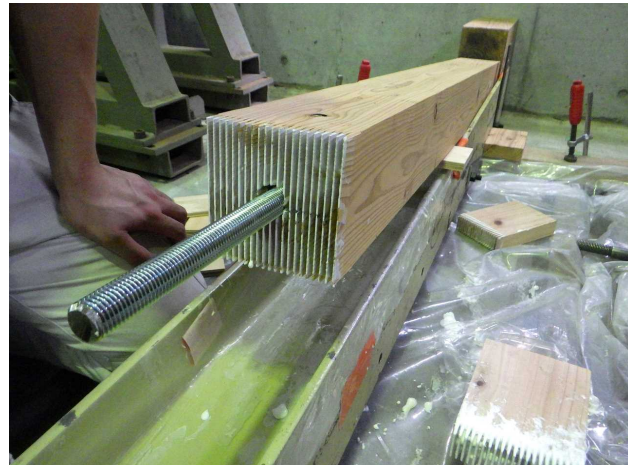
写真-1 下穴に GIR 鋼棒を挿入した様子
