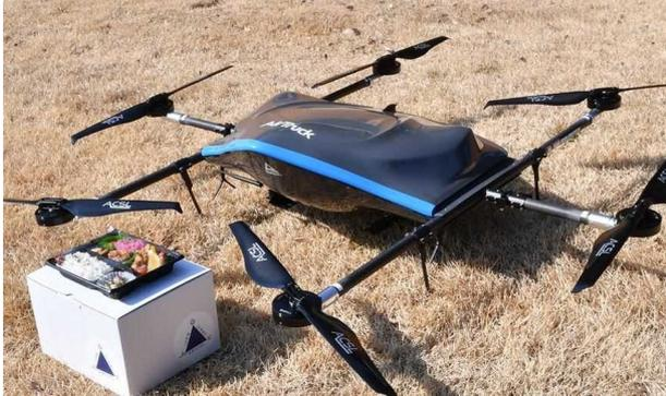
株式会社NEXT DELIVERYの親会社である株式会社エアロネクスト独自の機体構造設計技術4D GRAVITY®を搭載し、飛行部と荷物搭載部が分離した構造の、飛行性能、応答性能、着陸性能に優れた物流用途に特化した最新の物流専用ドローン。
