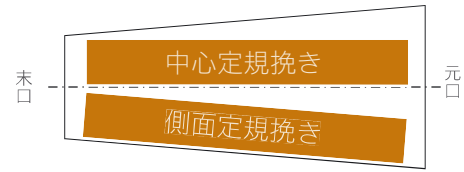
中心定規挽きと側面定規挽き
