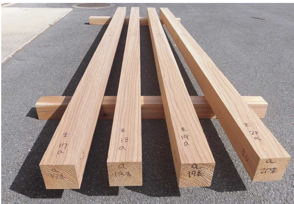
スギ大径丸太 1本から取れた心去り正角材
