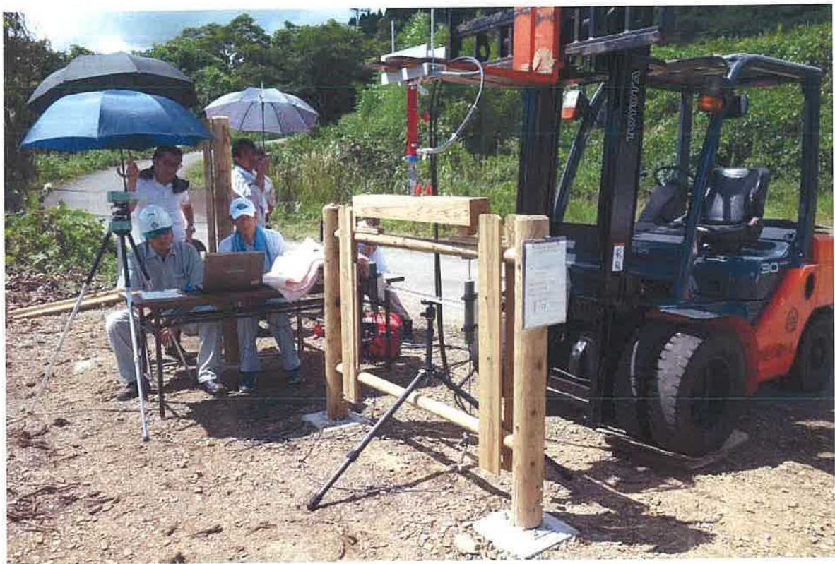
図 2. 3 境界フェンスの鉛直荷重試験の様子
