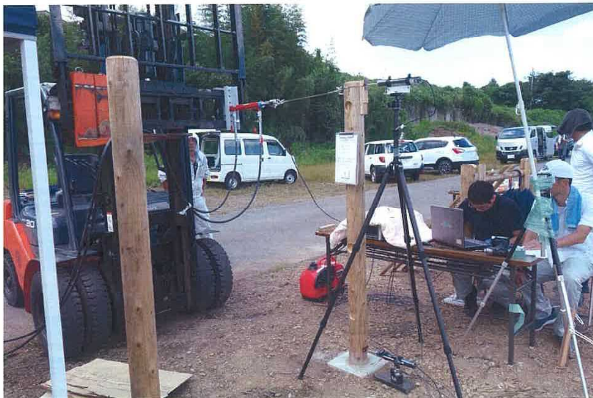
図 2. 8 目隠しフェンス用支柱の水平荷重試験の様子
