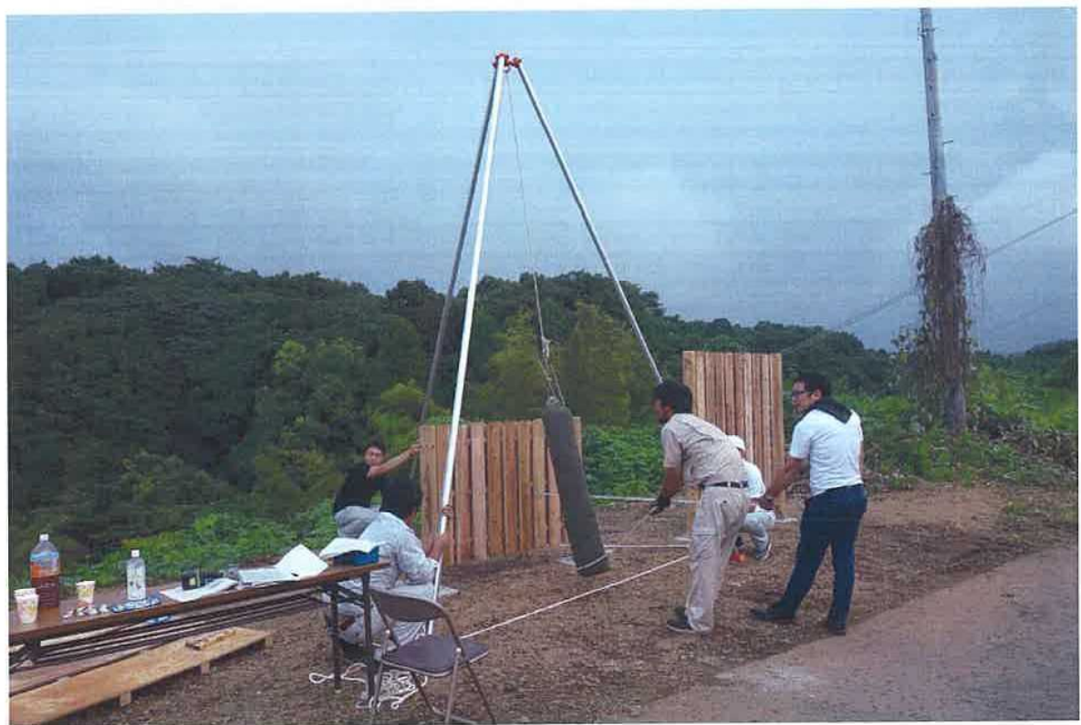
図2. 1 2 境界フェンスの衝撃試験の様子
