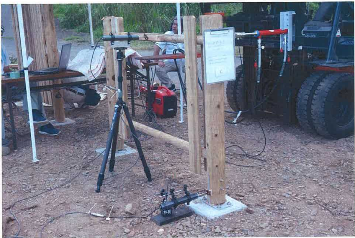
図 2. 6 境界フェンスの水平荷重試験の様子
