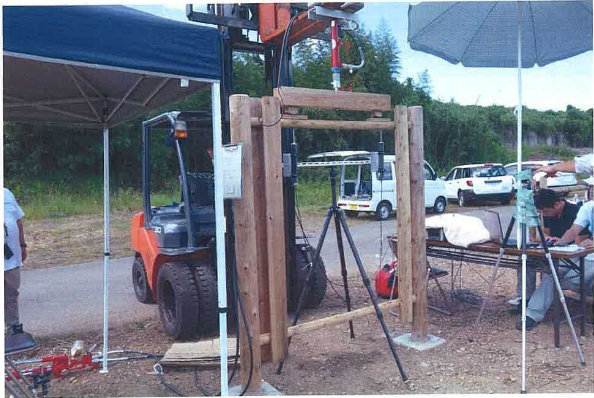
図 2. 2 目隠しフェンスの鉛直荷重試験の様子
