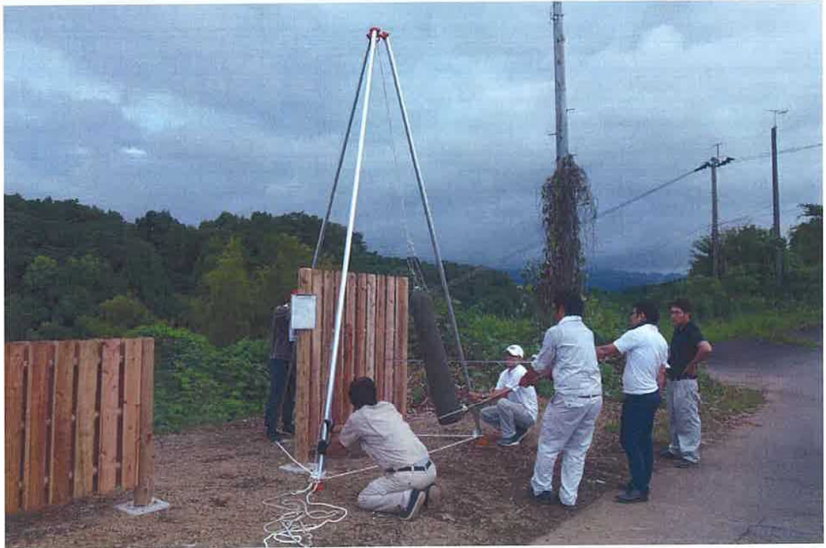
図2. 1 1 目隠しフェンスの衝撃試験の様子
