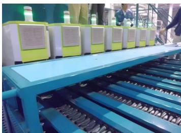
柑橘選果場に導入された精度の高い非破壊果実品質センサー
