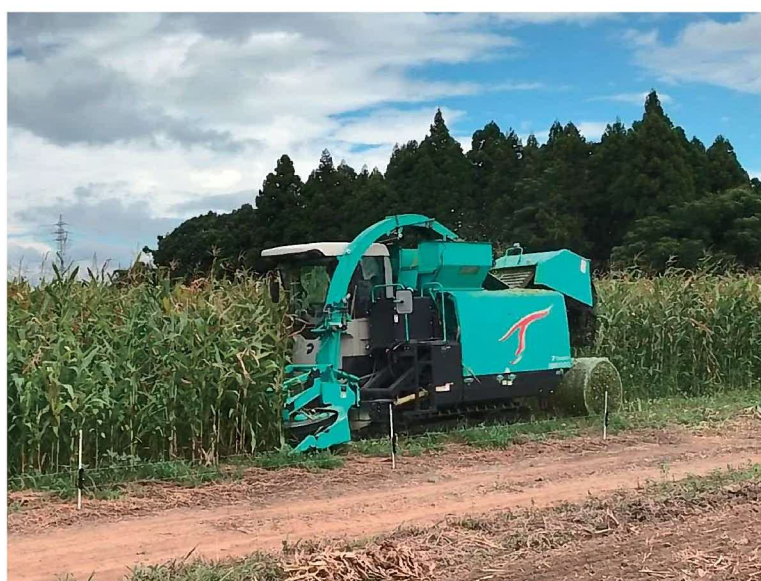
汎用収穫機を用いた飼料用トウモロコシの収穫(日田市)
